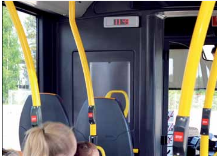
HSL:n mukaan tarkastajat löysivät viime syksyn tutkimuksessa puutteita lähinnä sisäkattojen, sisäseinien ja tukitankojen kunnossa sekä matkustamon kellon toiminnassa. Tässä Veolian bussissa kaikki on kunnossa.
