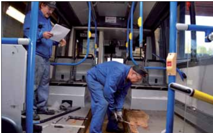
Työnjohtaja Jukka Nieminen (vas.) seuraa, kuinka asentaja Ari Lehtimäki purkaa huonokuntoisia lattiarakenteita, jotta uutta päästään rakentamaan tilalle.
