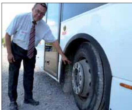
Korin kolhujen lisäksi liian hätäisistä käännöksistä kärsivät myös renkaat. Jori näyttää, miten kiveysten osumat näkyvät renkaiden sivujen vaurioina.
