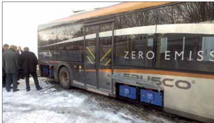
Ebuscon täyssähköbussi testiradalla. Esisarjan autoa odotetaan testeihin Suomeen maaliskuussa. Ebuscoa on jo ajettu talvisissa oloissa, kuten alempi kuva kertoo. Sivuluukkujen takaa löytyvät auton akut.
